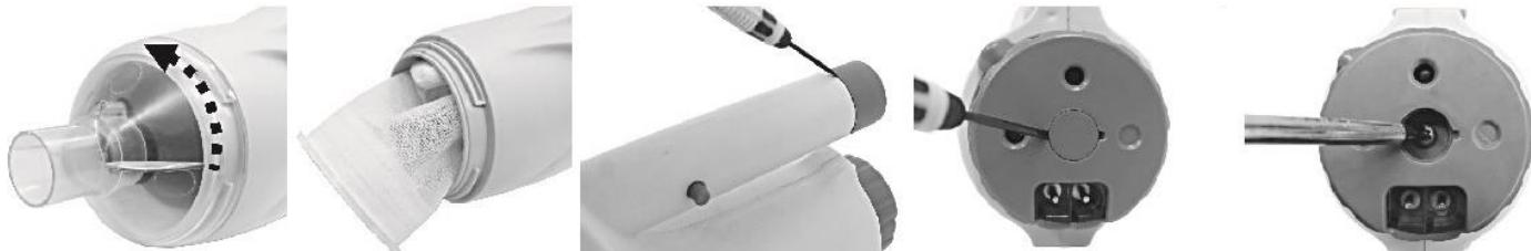
2. Odvojite prekidač i pomoću odvrtača Philips odvrnите sve šrafove na glavnom telu. Razdvojite telo u dve polovine da biste pristupili glavnoj komori.
