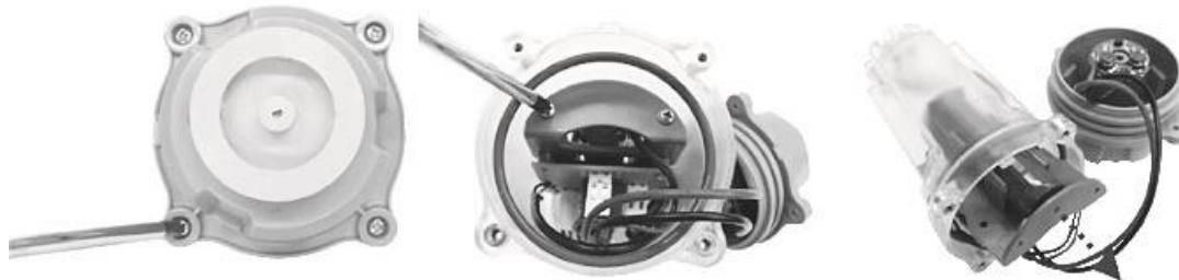
4. Uklonite kompletno kućište baterije (sa instaliranim baterijom) iz komore. Da biste odvojili kabl baterije, pritisnite priključak na konektoru i izvucite kabl. Zavrnite konektor odmah sa izolacijskom trakom kako biste izbegli kratak spoj izazvan kontaktom oba žičana priključka.
