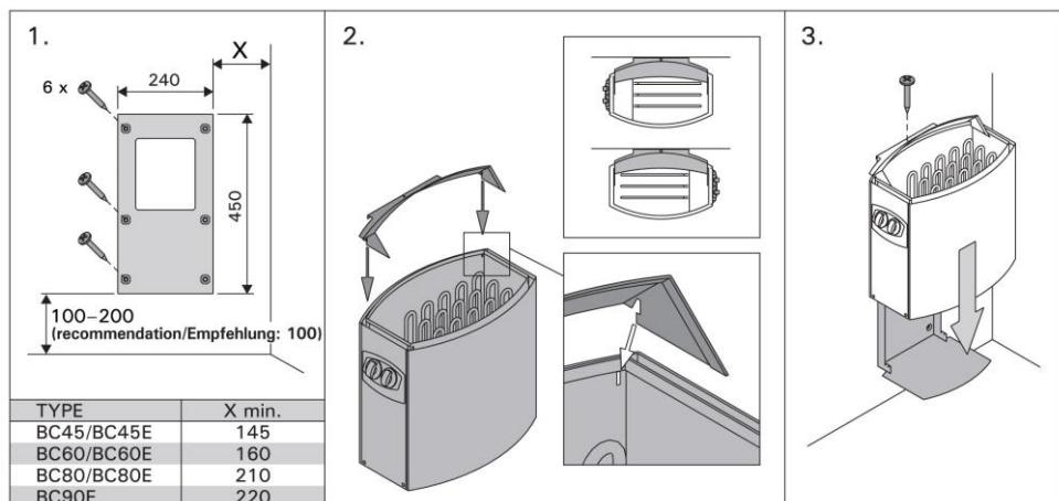
Pričvršćivanje peći na zid(dimenzije u milimetrima)
